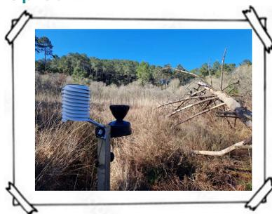
Depuis l'automne 2023, la réserve s'est équipée d'une **station météo** (baromètre, anémomètre, thermo-hygro-mètre, pluviomètre, pyranomètre) afin notamment de pouvoir **mieux quantifier certains paramètres en lien avec le changement climatique**. L'année 2024 est la première année où la réserve dispose d'une série de données météorologiques complète sur un an.
